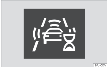
Obr. 156 Na displeji panelu přístrojů: signalizace první automatické kalibrace systému.
