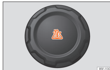
Obr. 189 Motorový prostor: uzávěr vyrovnávací nádobky chladicí kapaliny motoru.
